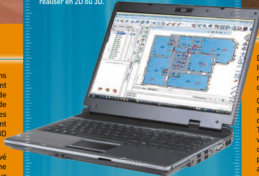
Copie d'écran du logiciel sur le terrain : levé mixte Télémètre & Théodolite
